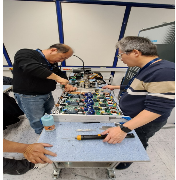
電源拆換實作
