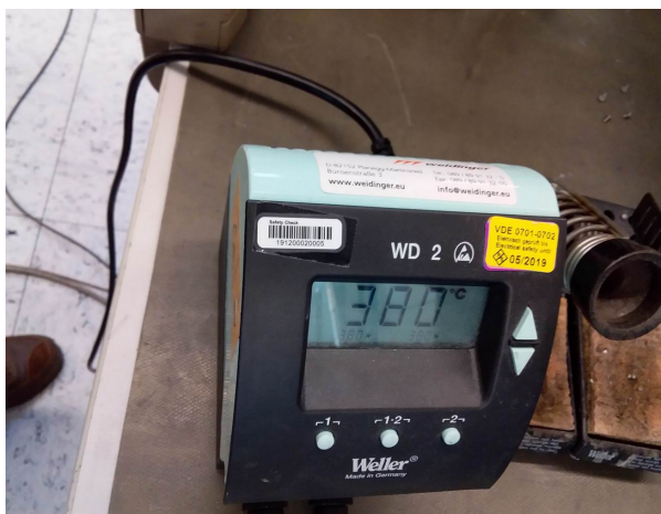
焊接用烙鐵溫度控制器設定
